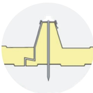
Los paneles Termo-Aislantes IC-CUBER PUR-1000 están compuestos por dos láminas de acero Galvanizado Prelacado Silicona Poliéster, unidas por un núcleo de espuma rígida de PUR de alta densidad.
